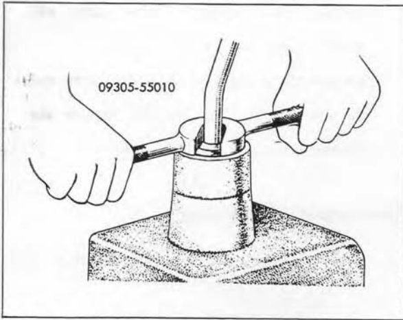
Fig. 3-6. Gear Shift Lever Removal
