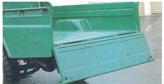
*L'arrière de la benne, retenue par des crochets, se rabat pour permettre le chargement.*
