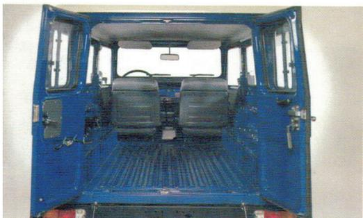
*L'accès à l'intérieur du châssis long est facilité par la double porte. Le véhicule supporte une charge allant jusqu'à 950 kg.*
