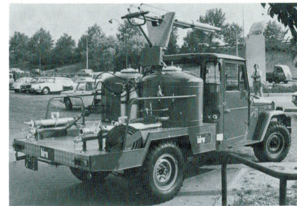
Equipement incendie à poudre sur chassis long
