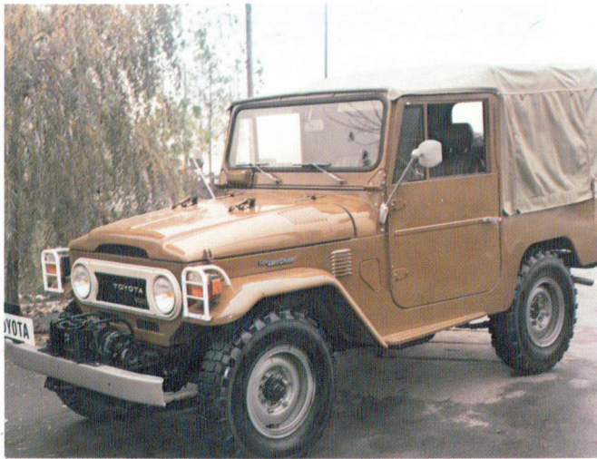
Chassis court bâché 6 cylindres essence ou 4 cylindres Diesel (94 CV)
