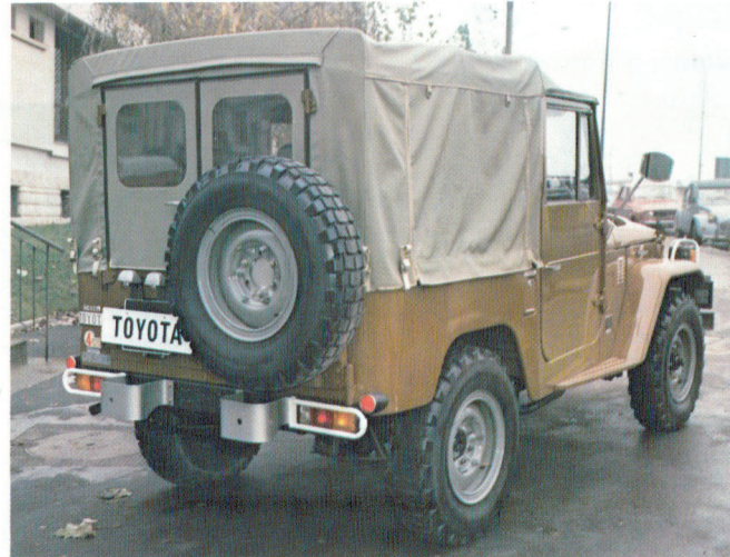
Partie AR du chassis court : 2 portes sur le modèle bâché ou Hayon supérieur pour le modèle tôlé
