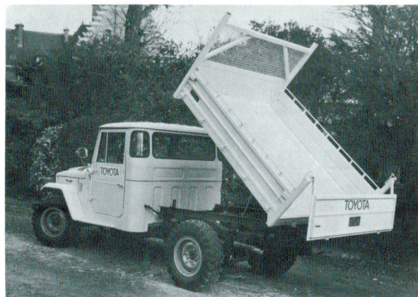
Pick up avec benne électro-hydraulique
